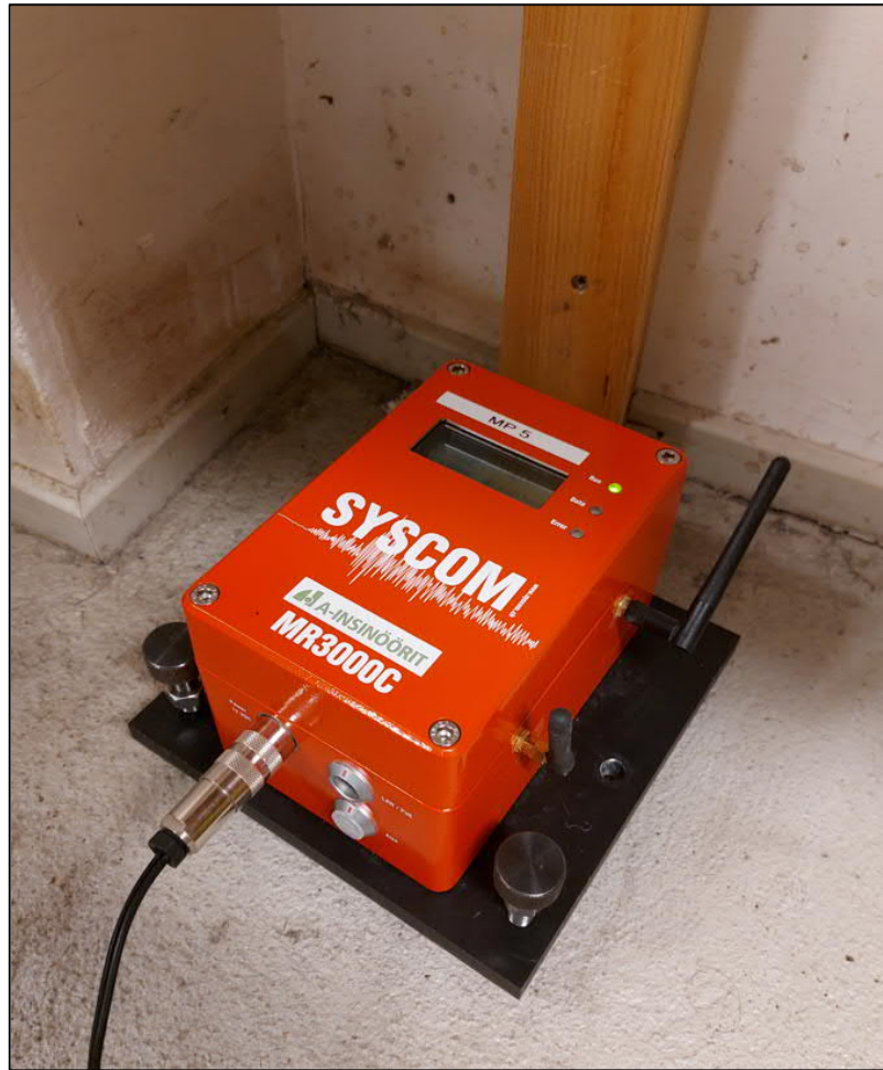
Kuva 5.2. Tärinämittarin asennus kellarin lattialle.
